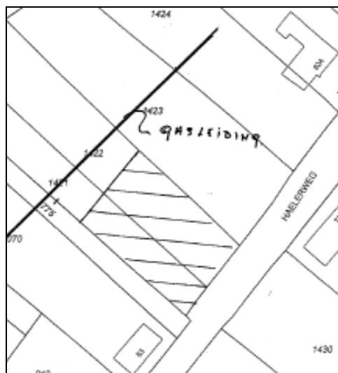
Figuur 4a: Situatietekening gasleiding
